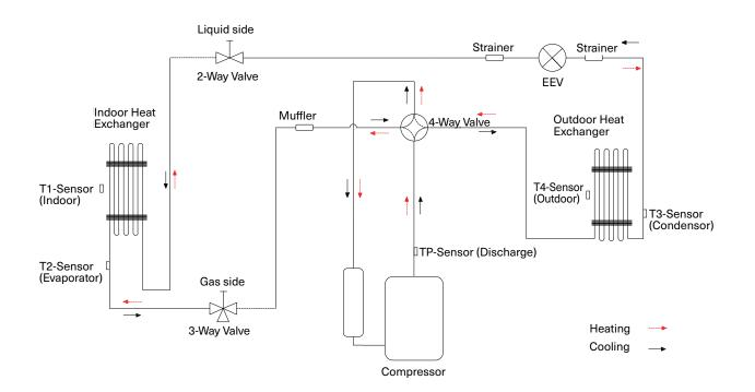
MOX230-09HFN10-B1E, MOX230-12HFN10-B1E, MOX230-09HFN10-M1E, MOX230-12HFN10-M1E
